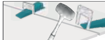
Una volta indurita la colla sarà sufficiente un colpo con una mazzuola in gomma per rimuoverlo.
